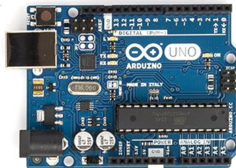
Fig.7 Arduino Uno Board
