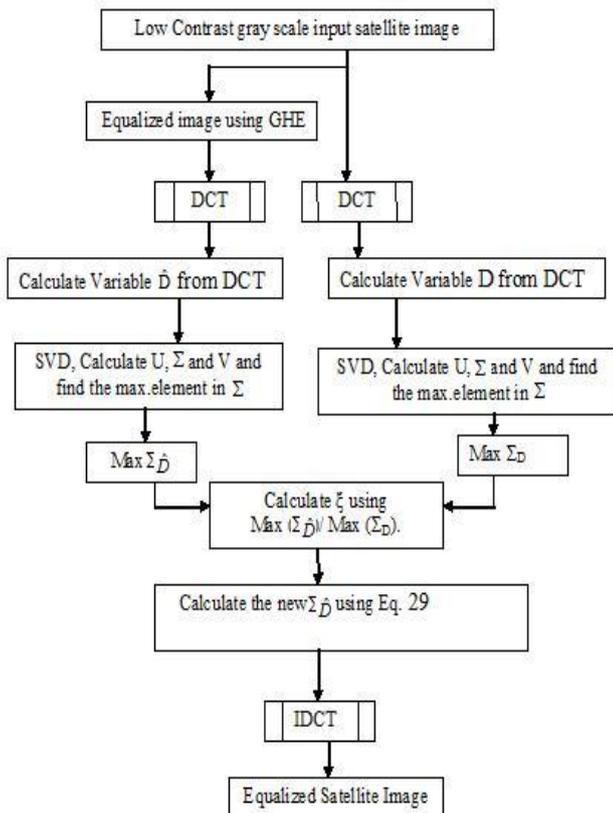
Fig. (d) Detailed steps of the DCT-SVD technique
