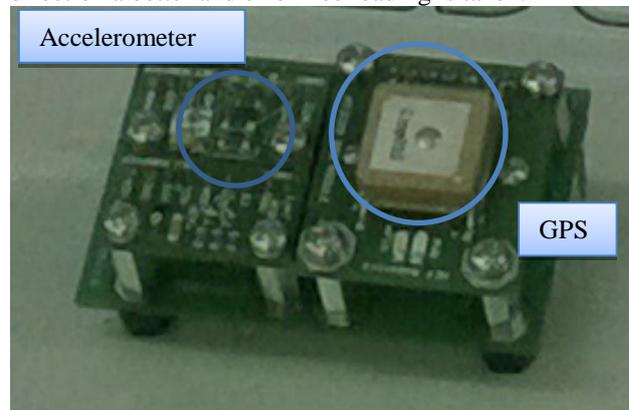
Figure VI. Sensor module
